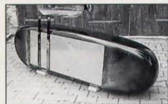
Neue Mischung: Aluminium und GfK im modernen Beiwagenbau.
