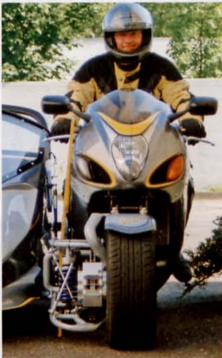
Die Höhe des Motorrades hat sich nicht geändert. Aber durch die geänderte Sitzposition (Abb. linke Seite) verschwindet der Fahrer nahezu völlig hinter der Verkleidung.
