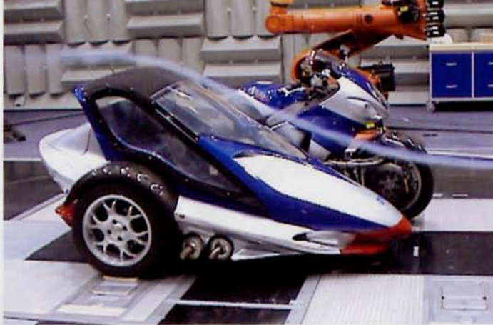
Links die Originalversion des Hayaruko-Gespannes im Windkanal. Durch den Wegfall des Kabinenaufbaus sinkt der Luftwiderstand deutlich.
