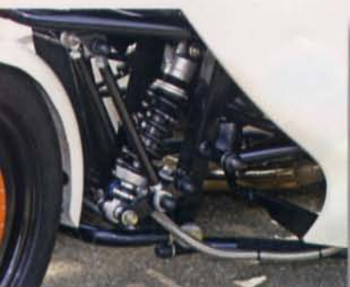
Ein Wilbers-Federbein sorgt für den guten Kontakt des Vorderrades zum Asphalt.
