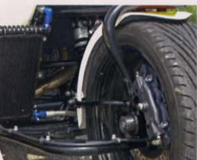
Volle Breitseite: Der Kühler der Suzuki wurde in den Fahrtwind gelegt.
