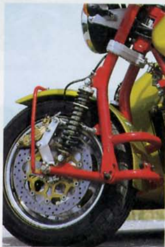
Aufwendig verstärktes Chassis mit gezogener Schwinge am Vorderrad.
